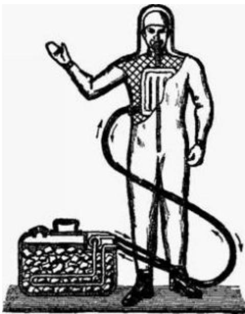
Рис. 9. Принцип вынесения: раньше горноспасатель носил на спине ранец с холодильным устройством; теперь оно помещено в отдельном контейнере.
