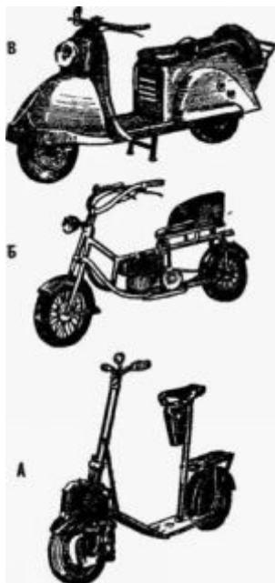
Рис 33 Путь совершенствования мотороллера-*А* - модель 1920 г; *Б* - промежуточная модель, *В*-машина современного вида.
